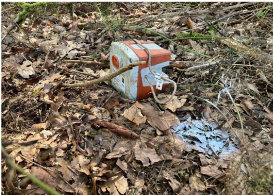
Des géophones de surface sont implantés dans le sol à des intervalles de 10 m.
