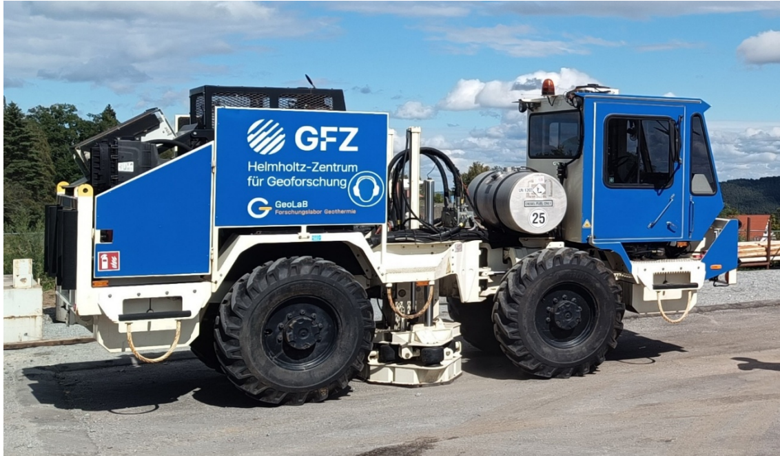
Camion vibreur sismique Inova Univib 326, poids: 13 t, largeur: 2.11 m, longueur: 6.32 m, hauteur: 3.0 m.
